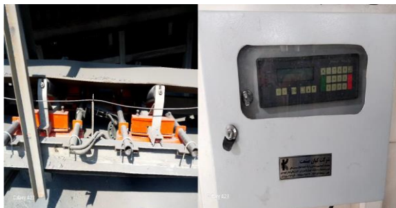
سیستم توزین جدید جهت اندازه گیری تناژ خوراک آسیای ریماس کارخانه ۳ تغییرات عیار ماده معدنی ورودی (خوراک) به کارخانجات فلوتاسیون طی سال های ۱۳۹۷ تا ۱۴۰۲
